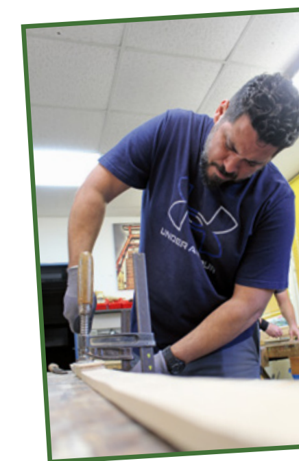
Fixiert ist das Holz im Schraubstock, fokussiert der Blick: Mit dem Ziehmesser tragen Mohamed Allali (links) und Peter Kmoch Span für Span ab, um den Wurfarm des Bogens in Form zu bringen.
